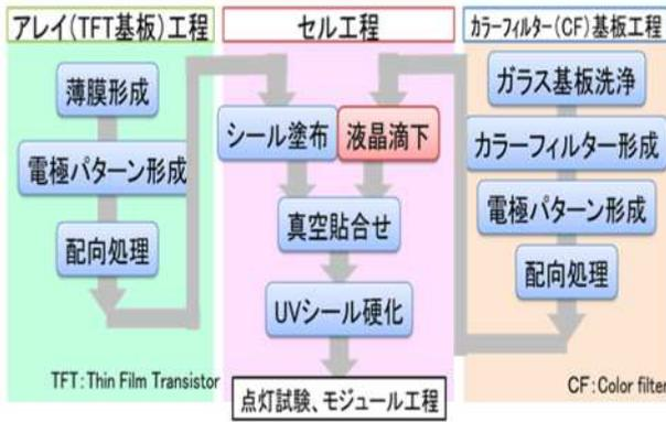
イが作り込まれたガラス基板と、カラー表示をするためのカラーフィルタ基板を貼り合せ、その間に液晶材料を封入する組立工程であり、液晶パネルの表示性能を左右する重要な工程でもある。
