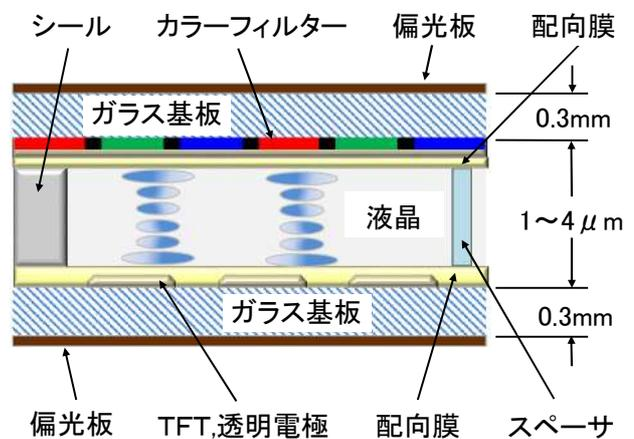
図5 液晶パネルの断面形状
